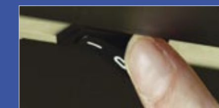
Karmvärme kan kopplas på och av manuellt med en strömbrytare.
